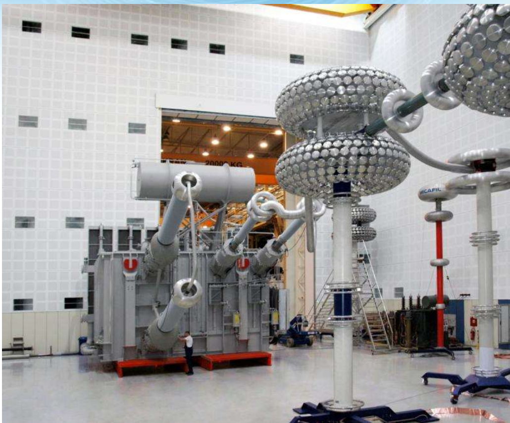
Transformator za istosmjerni prijenos energije HVDC 271 MVA, Novi Zeland
