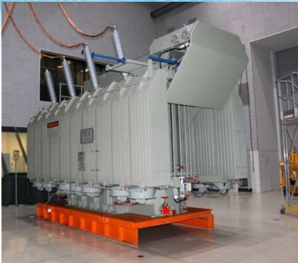
Trofazni uljem izolirani energetski transformator 40 MVA, Njemačka
