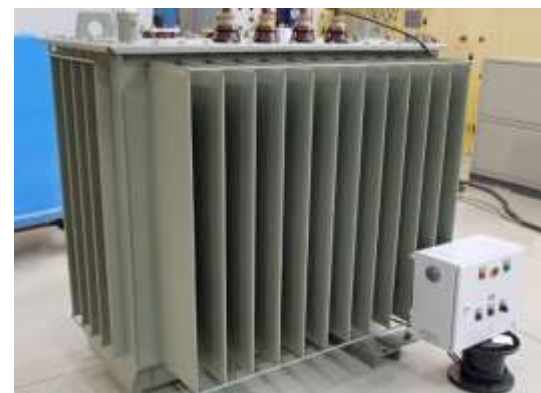
Trofazni uljem izolirani regulacioni transformator
