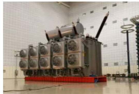
Trofazni autotransformator 350 MVA, Češka
