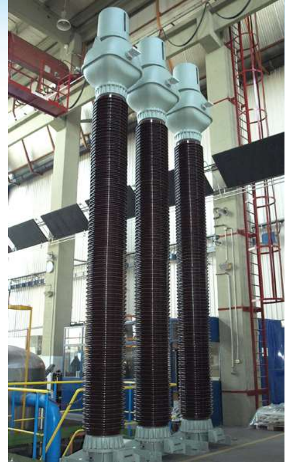
800 kV strujni mjerni transformator tip AGU-765
